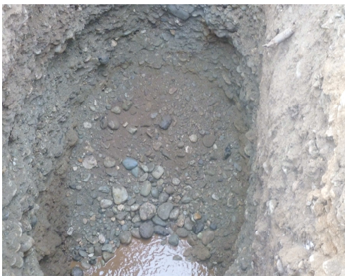
Foto 7: Trincea geognostica, falda a -5 m: Ghiaia e sabbia con ciottoli \varnothing_{\max} 35 cm. (Ditta Amambiente Srl).
