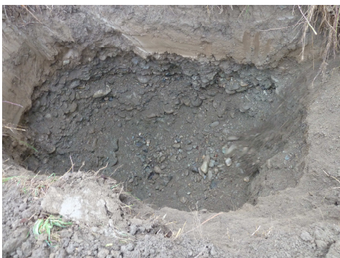
Foto 6: Trincea n.4, prof. -4 m: Ghiaia e sabbia con ciottoli \varnothing_{\max} 35 cm. Falda non rilevata.
